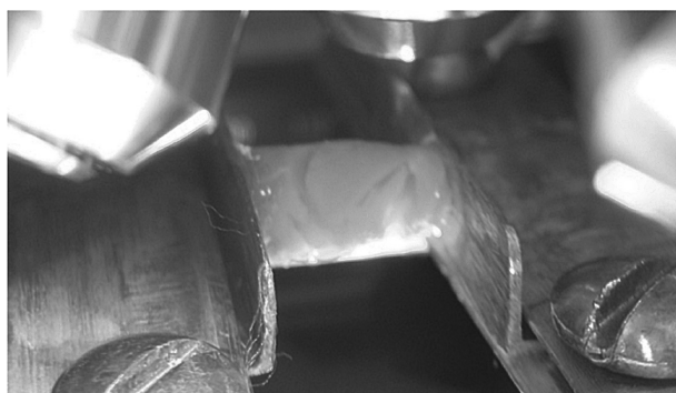
شکل ۱- نمونه استوانه‌ای شکل بافت مغز در دستگاه کشش محوری.
